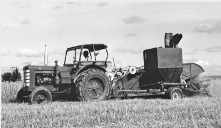
De bogserade tröskorna hade begränsad arbetsbredd och kapacitet men skillnaden var ändå revolutionerade jämfört med att skörda med självbindare och sen tröska hemma på logen.
