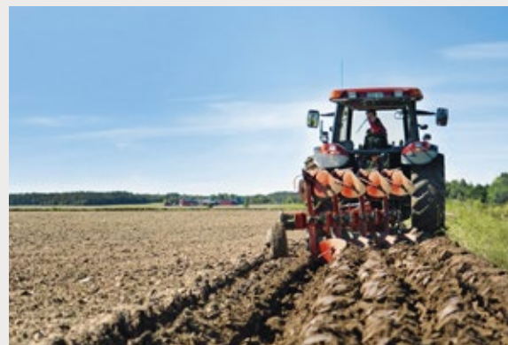
Sedan slutet på 1980-talet säljs i princip bara växelplogar, vilket ger både snabbare och bättre plöjning.
